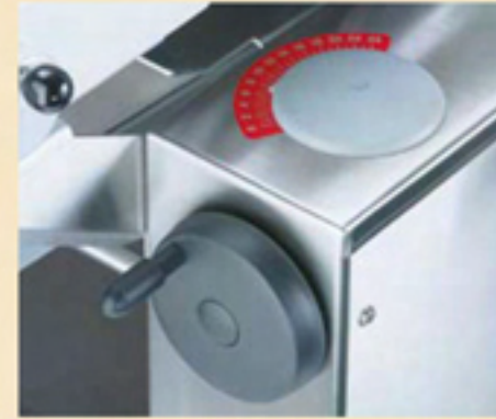
Die Wirkdruckplatte wird über ein leicht zugängliches Handrad auf den im Programm hinterlegten Wert eingestellt.
